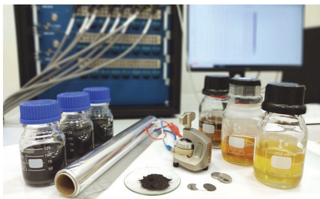
Die wichtigsten Komponenten einer Aluminium-Ionen-Batterie: Graphitpulver, Aluminiumfolie und ein spezieller Elektrolyt, der aus einer bei Raumtemperatur flüssigen Salzsäure besteht. Bild: Maximilian Wassner / Fraunhofer THM
